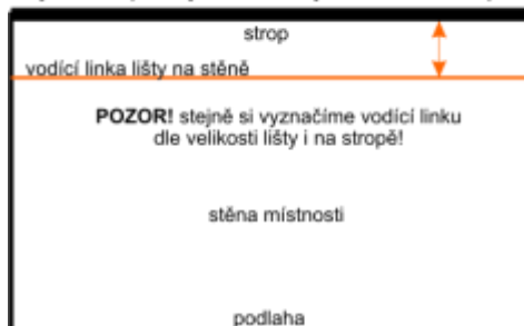
Vyměření polohy rohové lišty na stěně a stropu.
